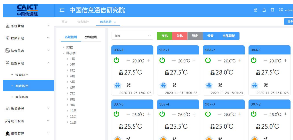
图 9 风机盘管集中监控系统
